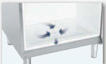
**Selbstschließende Tür** mit einfach **wechselbarer Magnetdichtung**. Zur komfortablen Bedienung bleiben die Türen bei einem Öffnungswinkel von 90° geöffnet, um größere Mengen bequem zu bestücken oder entnehmen zu können. Unter 60° schließen die Türen zuverlässig mit Hilfe der Magnetdichtung von selbst. Das verhindert Kälteverlust und trägt zu Energieeffizienz bei.
